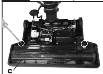
Para quitar la cubierta del rodillo de cepillado, retire los tornillos como se ilustra arriba y levante la cubierta para quitarla.
