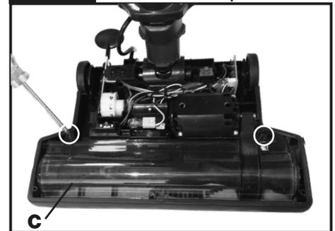
Para quitar la cubierta del rodillo de cepillado, retire los tornillos como se ilustra arriba y levante la cubierta para quitarla.
