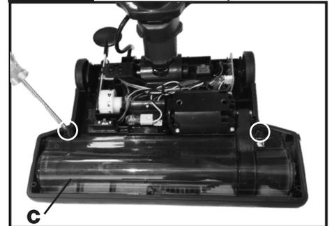
Para quitar la cubierta del rodillo de cepillado, retire los tornillos como se ilustra arriba y levante la cubierta para quitarla.
